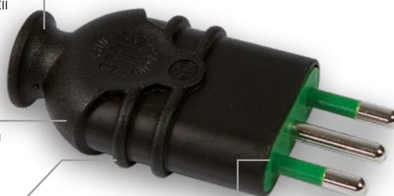
Cablaggio facilitato dalla posizione assiale delle viti che evita anche di scivolare sulla mano con l'utensile. Accetta cavi sino al 3G2,5 in PVC e 3G1,5 in cavo Neoprene H07RN-F.
