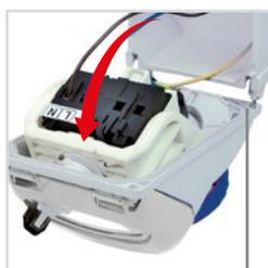
Free Hand System è il nuovo sistema di cerniere che velocizza e semplifica il montaggio delle prese. È sufficiente fissare la presa alle due estremità inferiori con 1-2 giri di vite e automaticamente la presa capovolgendosi in avanti permette all'operatore di avere entrambe le mani libere e poter operare in modo semplice e veloce il cablaggio dei cavi. Successivamente sarà sufficiente fissare totalmente le viti inferiori e superiori per avere la presa bloccata.
