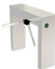
Tornello tripode elettromeccanico bidirezionale in acciaio con finitura spazzolata opaca, completo di scheda elettronica, indicatori luminosi a LED e deceleratore idraulico. Sblocco automatico del tripode in caso di blackout.
