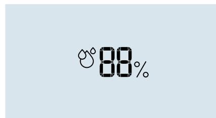
Indica il livello di umidità percentuale dell'ambiente rilevata grazie al sensore integrato all'interno del cronotermostato.
