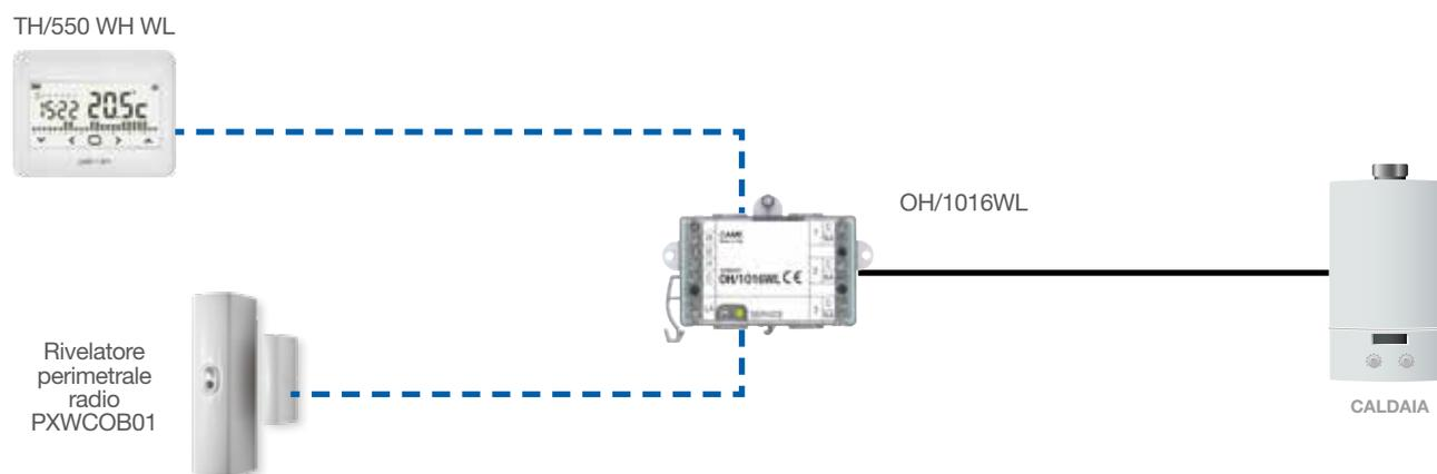
I sensori volumetrici dell'impianto antintrusione possono essere connessi al cronotermostato per rilevare la presenza di persone all'interno di una stanza. 2 ore dopo l'ultimo rilevamento, il sistema viene riportato automaticamente ad una temperatura preimpostata.
